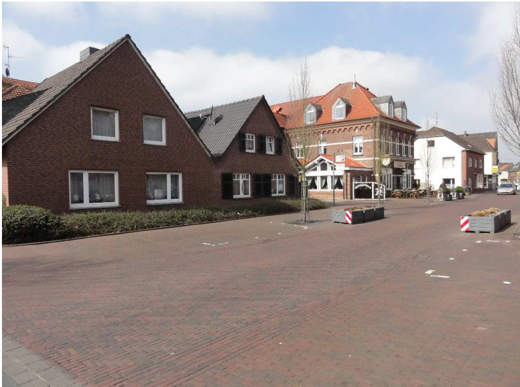
Bild 5 Situation der Großen Straße im östlichen Eingangsbereich – keine bauliche Trennung zwischen Gehweg / Fahrbahn
