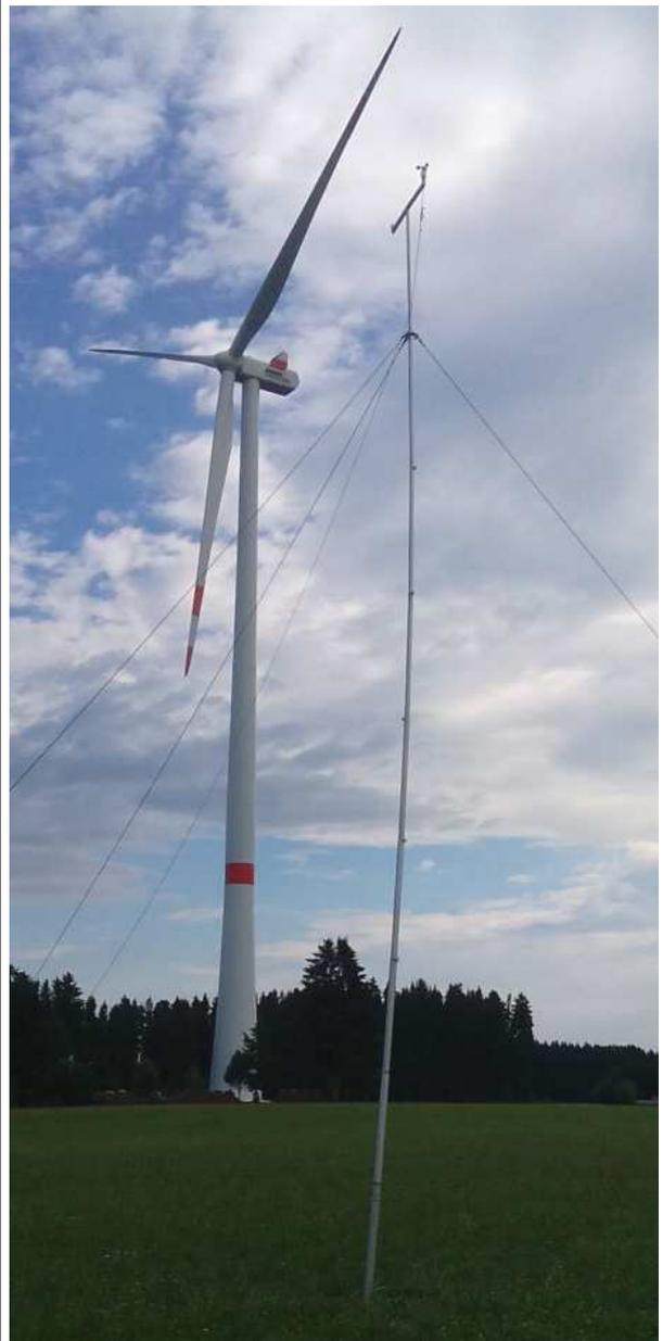
Abb. 3: Aufbau Windmessmast
