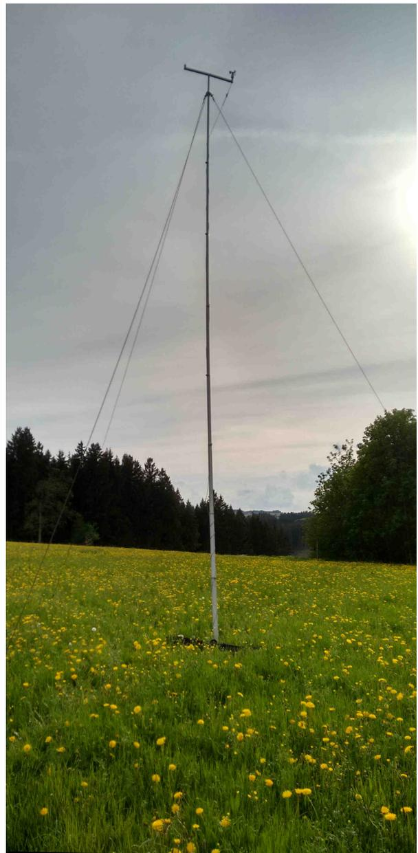
Abb. 3: Aufbau Windmessmast
