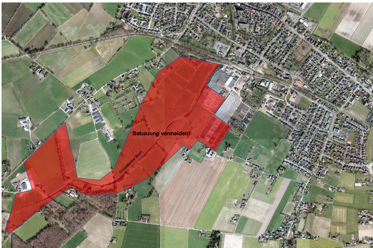
Abbildung 14: Beispiel von im Starkregenfall überfluten Flächen, auf der eine Bebauung vermieden werden sollte, Bereich Groesbeeker Bach
